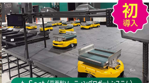
t-Sort (平面型ソーティングロボットシステム)
